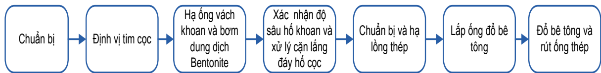
Hình 5: Quy trình thi công cọc khoan nhồi
