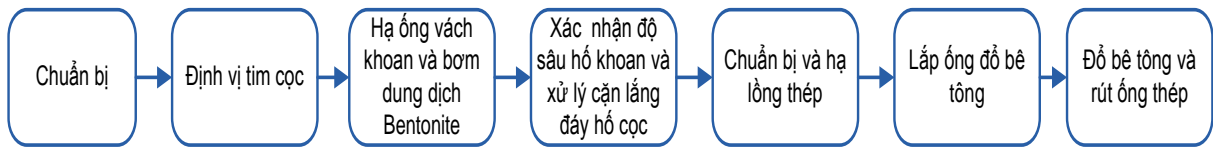
Hình 3: Quy trình thi công cọc khoan nhồi
